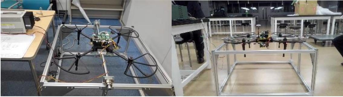
Fig.1 ジャイロアクチュエータ搭載ドローン実験装置
